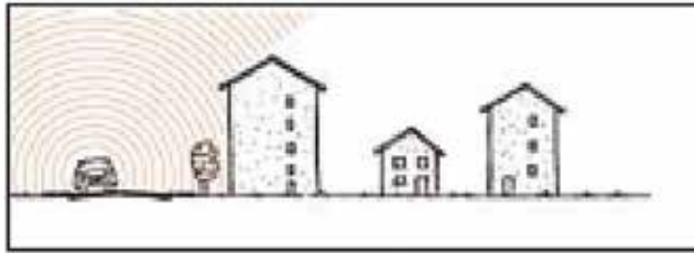
Graphique 3 : deux types d'aménagement de voisinages conçus pour produire une façade accalmie : à gauche une ligne-écran, à droite un design épannelé.
