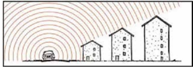
Graphique 3 : deux types d'aménagement de voisinages conçus pour produire une façade accalmie : à gauche une ligne-écran, à droite un design épannelé.
